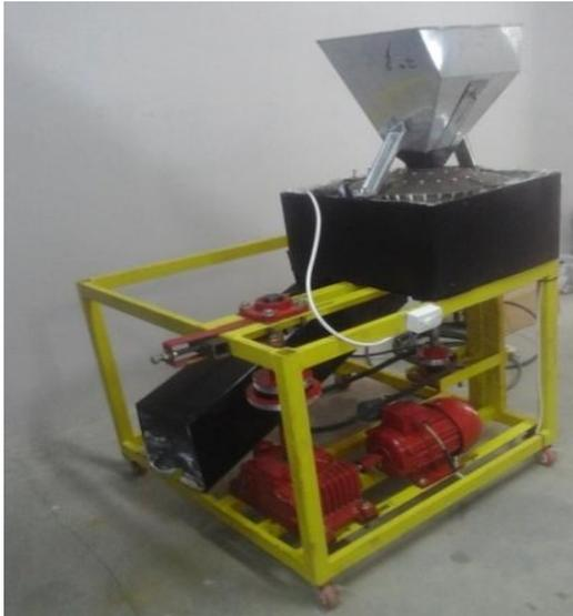
Gambar 5. Mesin Pengupas Kulit Luar Kacang Tanah Tipe Ruji Vertikal
