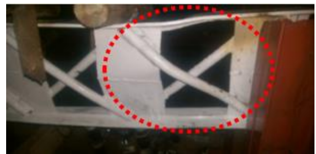
Gambar 7b Kondisi akhir setelah pembebanan
