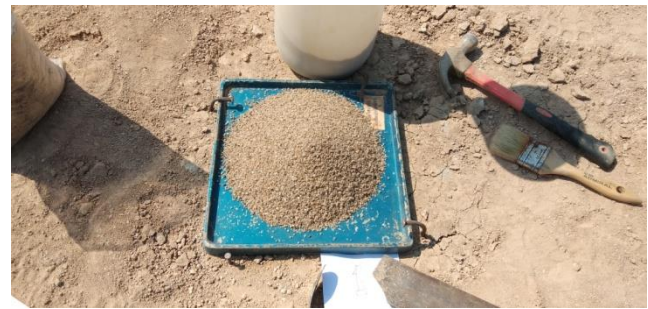
Gambar 6. Setelah Penuangan Pasir Kedalam Lubang
