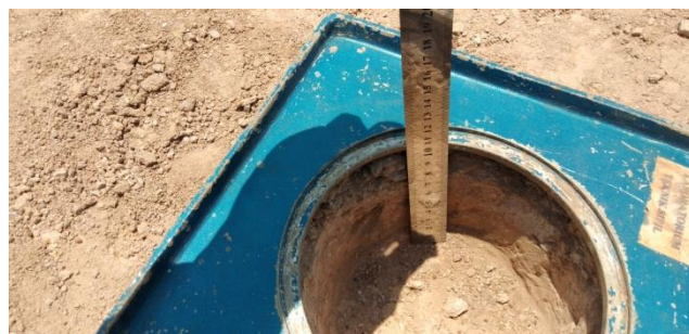
Gambar 4. Kedalaman lubang sampel sandcone Sumber : Dokumentasi Pengujian, 2019
