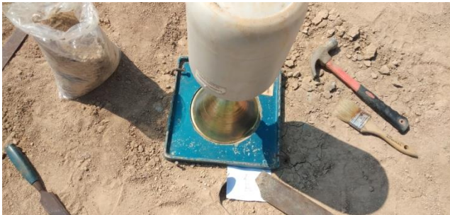
Gambar 5. Penuangan Pasir Kedalam Lubang Sumber : Dokumentasi Pengujian, 2019
