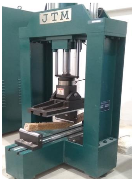
Gambar 3 Pengujian Kuat Lentur Balok Komposit Sekam Padi
