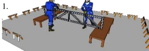
**Gambar 6.** Perakitan rangka utama Jembatan
