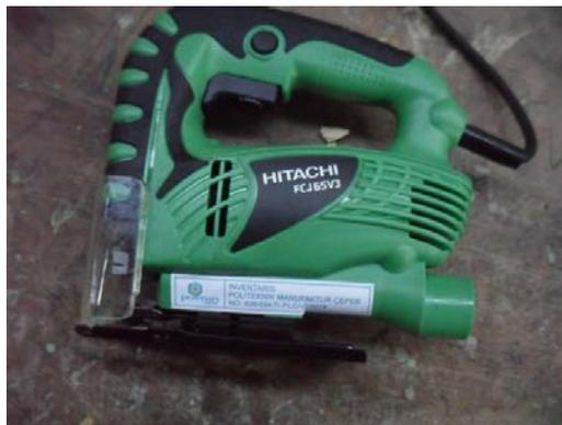
Gambar 4.2 Jig saw untuk menggergaji bentuk yang rumit
