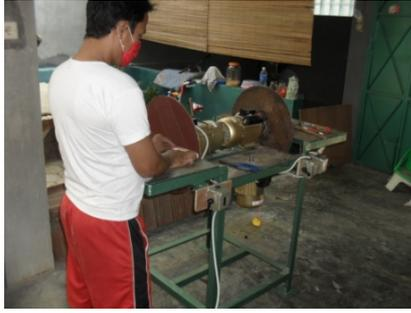
Gambar 4.1 mesin discander untuk permukaan luar dan permukaan dalam suatu lubang
