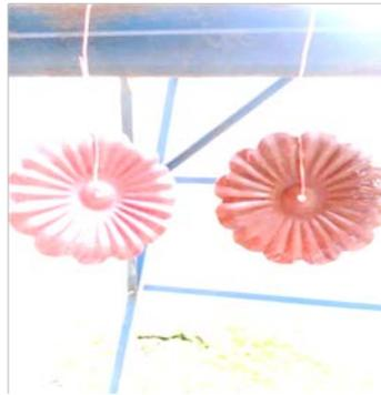
Gambar 3.6. Pengeringan Benda Kerja Setelah Dielektroplating
