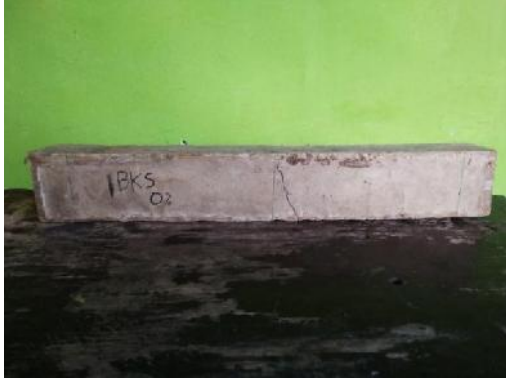
Gambar 4.5. Retak Kayu Sintetis BKS
