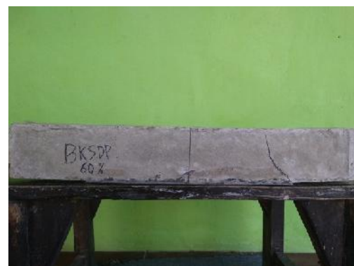
Gambar 4.5. Retak Kayu Sintetis BKSDP
