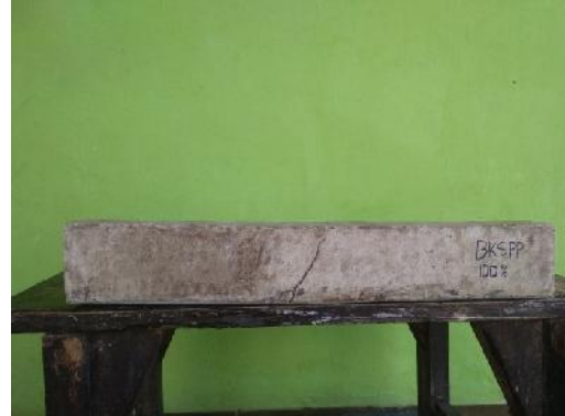
Gambar 4.5. Retak Kayu Sintetis BKSP
