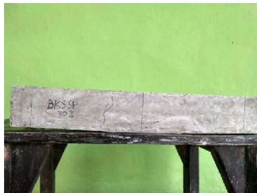
Gambar 4.5. Retak Kayu Sintetis BKSSP
