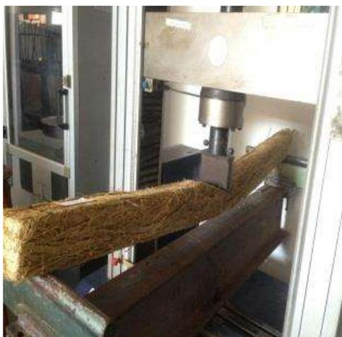
Gambar 3 Skema Pengujian Kuat Lentur
