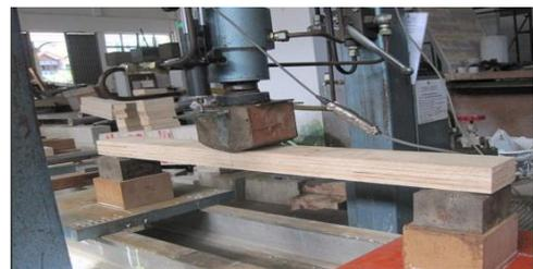
Gambar 1. Pengujian kuat lentur LVL kayu sengon
