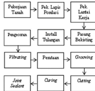
Gambar 4. Tahapan-Tahapan Pelaksanaan Perkerasan Kaku
