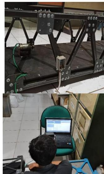
Gambar 6. Pengujian getaran pada struktur model.
