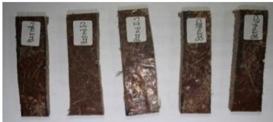
Gambar 1. Spesimen Pengujian Ketangguhan Impak.
