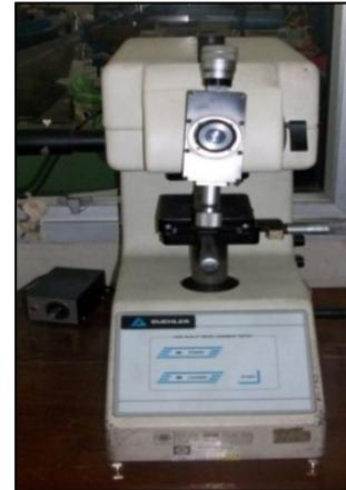
Gambar 2.3 Mesin Uji Kekerasan
