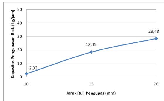
Gambar 8. Pengaruh jarak ruji pengupas terhadap kapasitas pengupasan baik (biji kacang tanah yang utuh)
