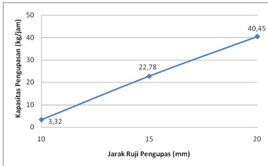
Gambar 7. Pengaruh jarak ruji pengupas terhadap kapasitas pengupasan
