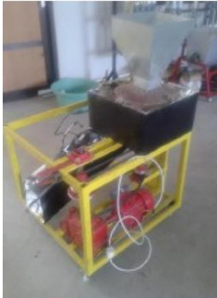
Gambar 4. Mesin pengupas kacang tanah
