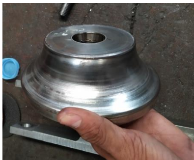
Gambar 4.4 Hasil pembuatan Roll
