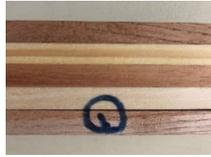
Gambar 6. Pola Kerusakan Benda Uji A<sub>34</sub>
