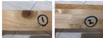
Gambar 7. Pola Kerusakan Benda Uji A<sub>04</sub>
