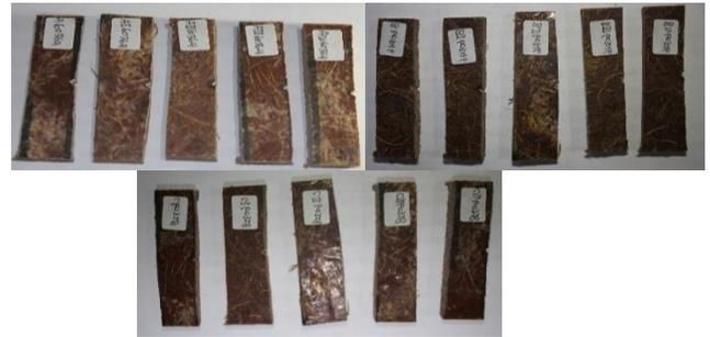
Gambar 1. Spesimen Pengujian Ketangguhan Impak.
