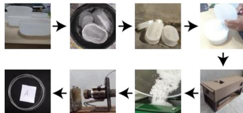
Gambar 2. Proses Ekstrusi Pembuatan Filamen
