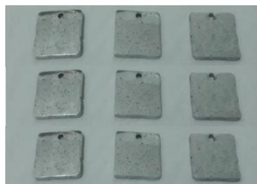
Gambar 3. Spesimen setelah di-*anodizing*
