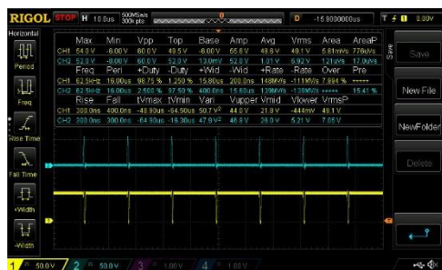
Gambar 4. 3 Respon Gelombang Keluaran Buck Converter
