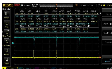
Gambar 4. 2 Bentuk Gelombang Sinyal PWM
