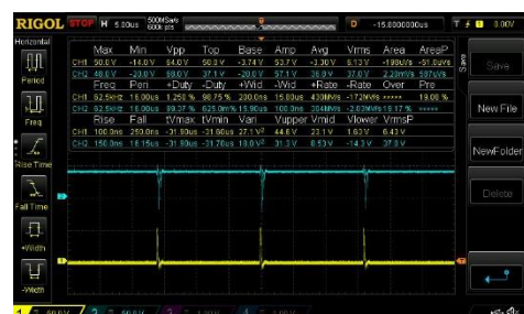
Gambar 4. 2 Bentuk Gelombang Sinyal PWM
