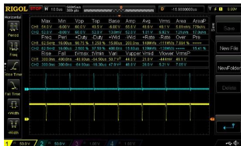
Gambar 4. 3 Respon Gelombang Keluaran Buck Converter
