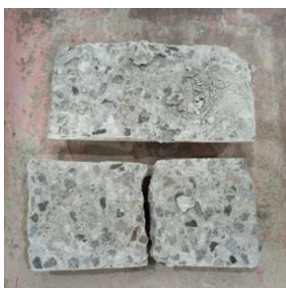
Gambar 7. Kerusakan Beton Setelah Uji Kuat Tarik Belah.
