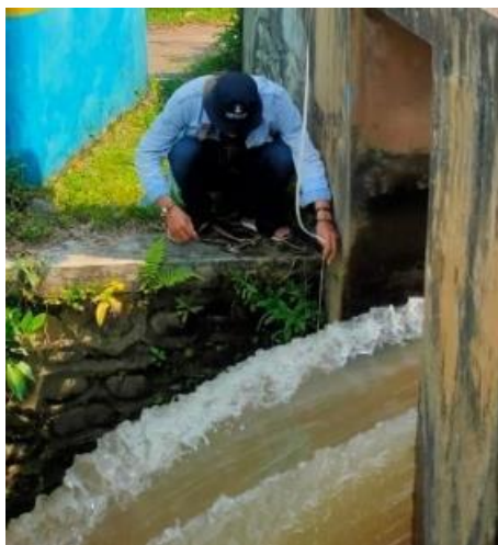
Gambar 1. Pengukuran ketinggian jatuh air
