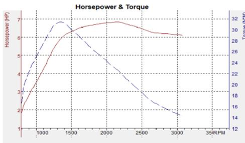
Gambar 3. Grafik hasil uji peforma mesin untuk daya pegas *racing*
