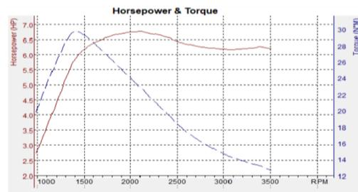
Gambar 2. Grafik hasil uji performa mesin untuk daya Pegas Standar
