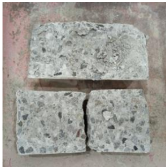
Gambar 10. Kerusakan Beton Setelah Uji Kuat Tarik Belah.
