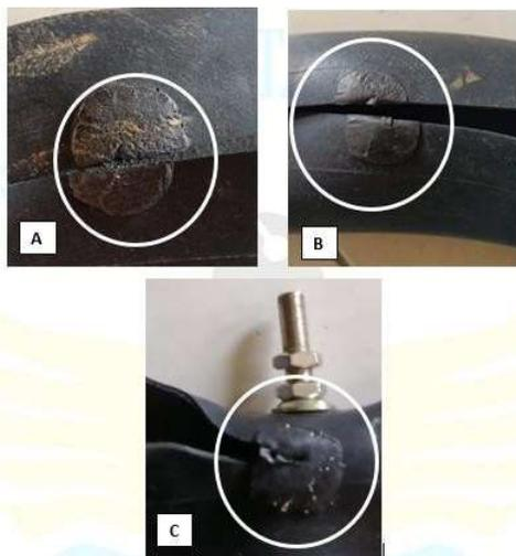
Gambar 9 Foto makro robekan hasil tambalan : (A) Hasil tambalan dengan variasi suhu (B) Hasil tambalan dengan variasi waktu (C) Hasil tambalan dengan variasi waktu dengan *pressing valve*
