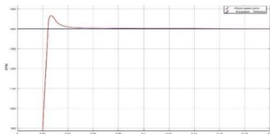
Gambar 16 Respon kecepatan 1400 rpm tanpa PID
