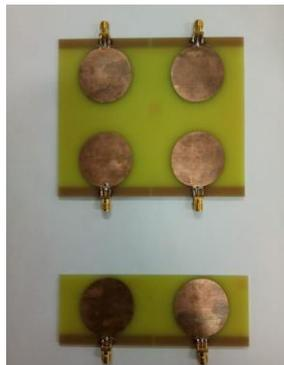
Gambar 10. Hasil Fabrikasi Antena 2x2 dan 4x4
