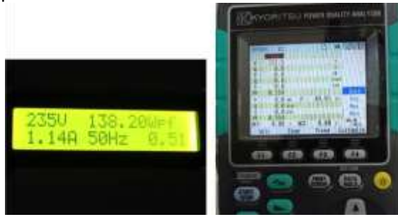
Gambar 14. Perbandingan pengukuran frekuensi menggunakan zero crossing detector dengan pengukuran frekuensi menggunakan Power Quality Analyzer
