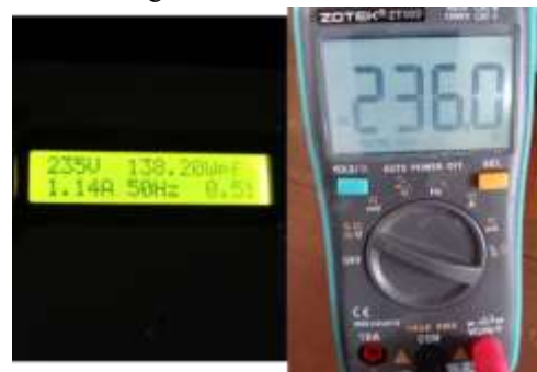
Gambar 7. Perbandingan pengukuran tegangan antara sensor tegangan dan voltmeter
