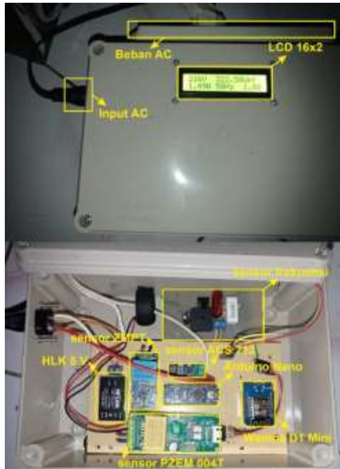
Gambar 3. Hasil pembuatan sistem monitoring tegangan, arus, daya, faktor daya, dan frekuensi yang sudah jadi beserta penjelasan tiap bagian-bagiannya
