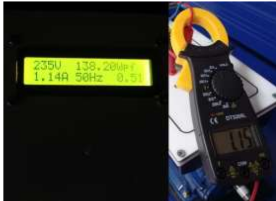
Gambar 11. Perbandingan pengukuran arus antara sensor arus dan clampmeter
