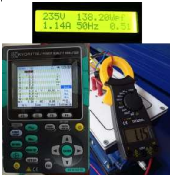
Gambar 16. Perbandingan pengukuran daya nyata (active power) menggunakan perangkat dengan pengukuran daya nyata (active power) menggunakan Power Quality Analyzer
