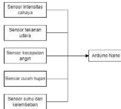
Gambar 9 Diagram blok perangkat
