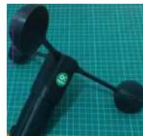
Gambar 3 Sensor kecepatan angin
