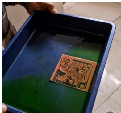
Gbr. 4 Pelarutan papan PCB menggunakan cairan feriklorit
